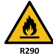
**Dieses Gerät ist nur für die Verwendung mit dem Kältemittel R290 (Propan) vorgesehen, das, unter Druck stehend, hermetisch im Kältemittelkreislauf eingeschlossen ist. Reparaturen an diesem Gerät dürfen nur von einem speziell geschulten Servicetechniker gemäß der nationalen Gesetzgebung zu brennbaren Stoffen durchgeführt werden! Nicht in den Kühlkreislauf eingreifen, Leitungen durchstechen oder höheren Temperaturen aussetzen.**
