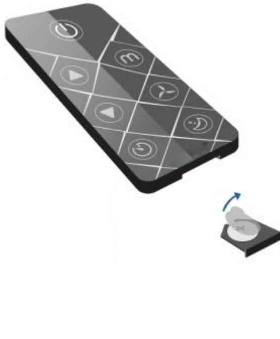
Einlegen der Batterie (ist im Lieferumfang enthalten) Bei Erstinbetriebnahme muss die Plastikabdeckung von der Batterie entfernt werden.
