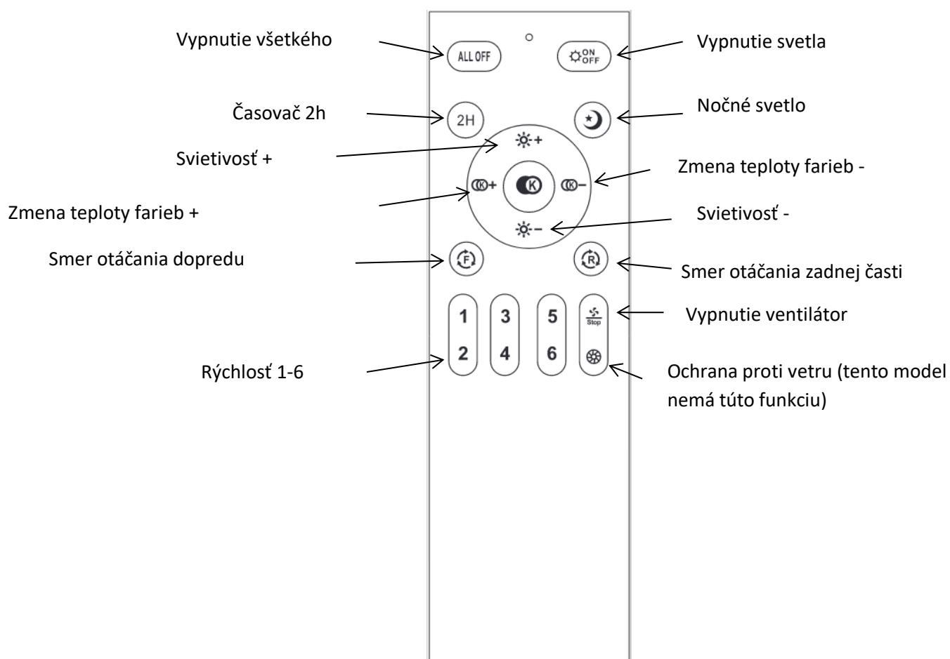
Diaľkové ovládanie nevyžaduje žiadne špeciálne párovanie a možno ho používať hned po inštalácii ventilátora.
