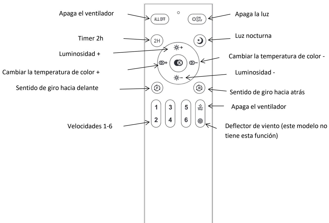
El mando a distancia no requiere ningún emparejamiento especial y puede utilizarse en cuanto se instala el ventilador.
