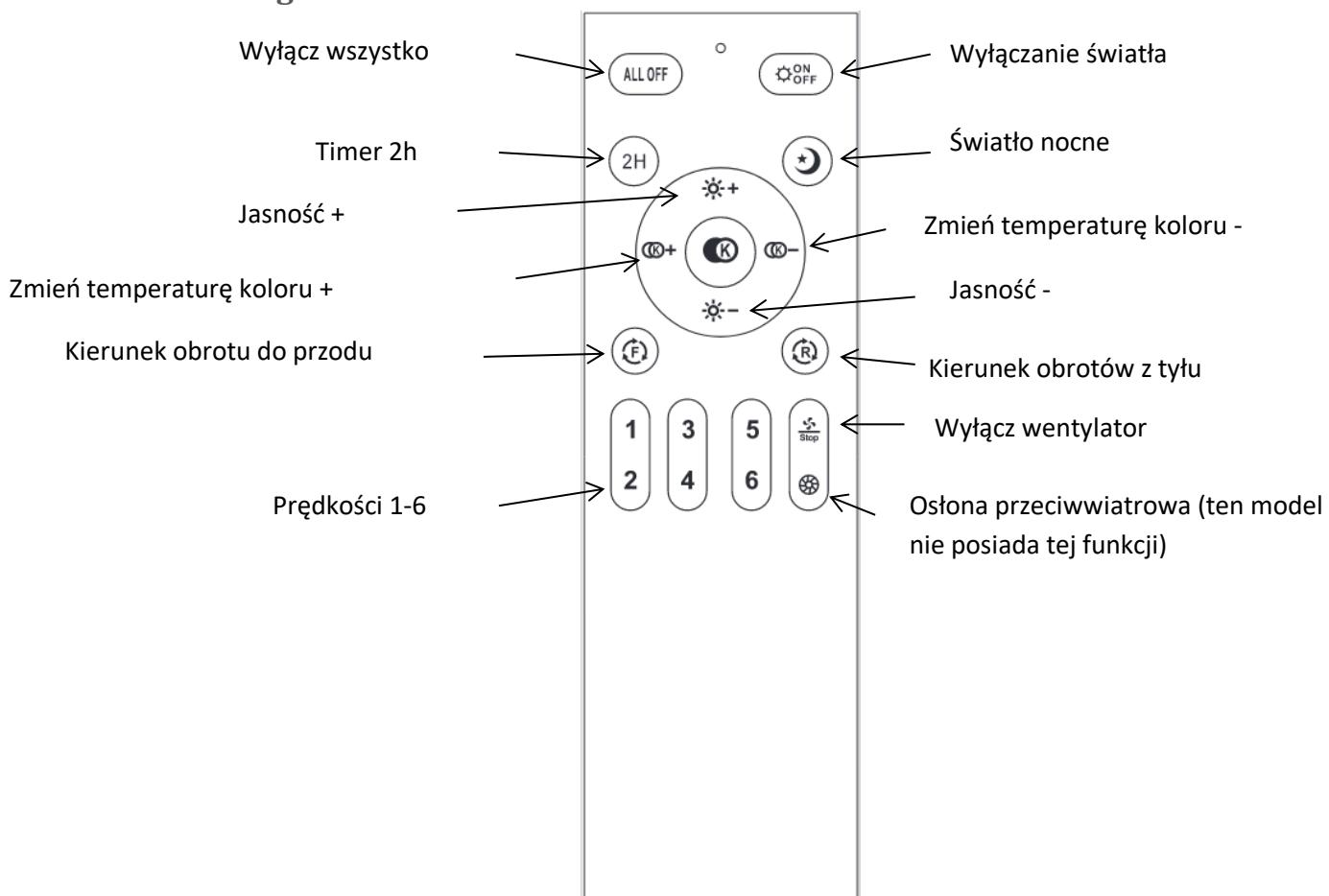
Pilot nie wymaga specjalnego sparowania i można go używać zaraz po zainstalowaniu wentylatora.
