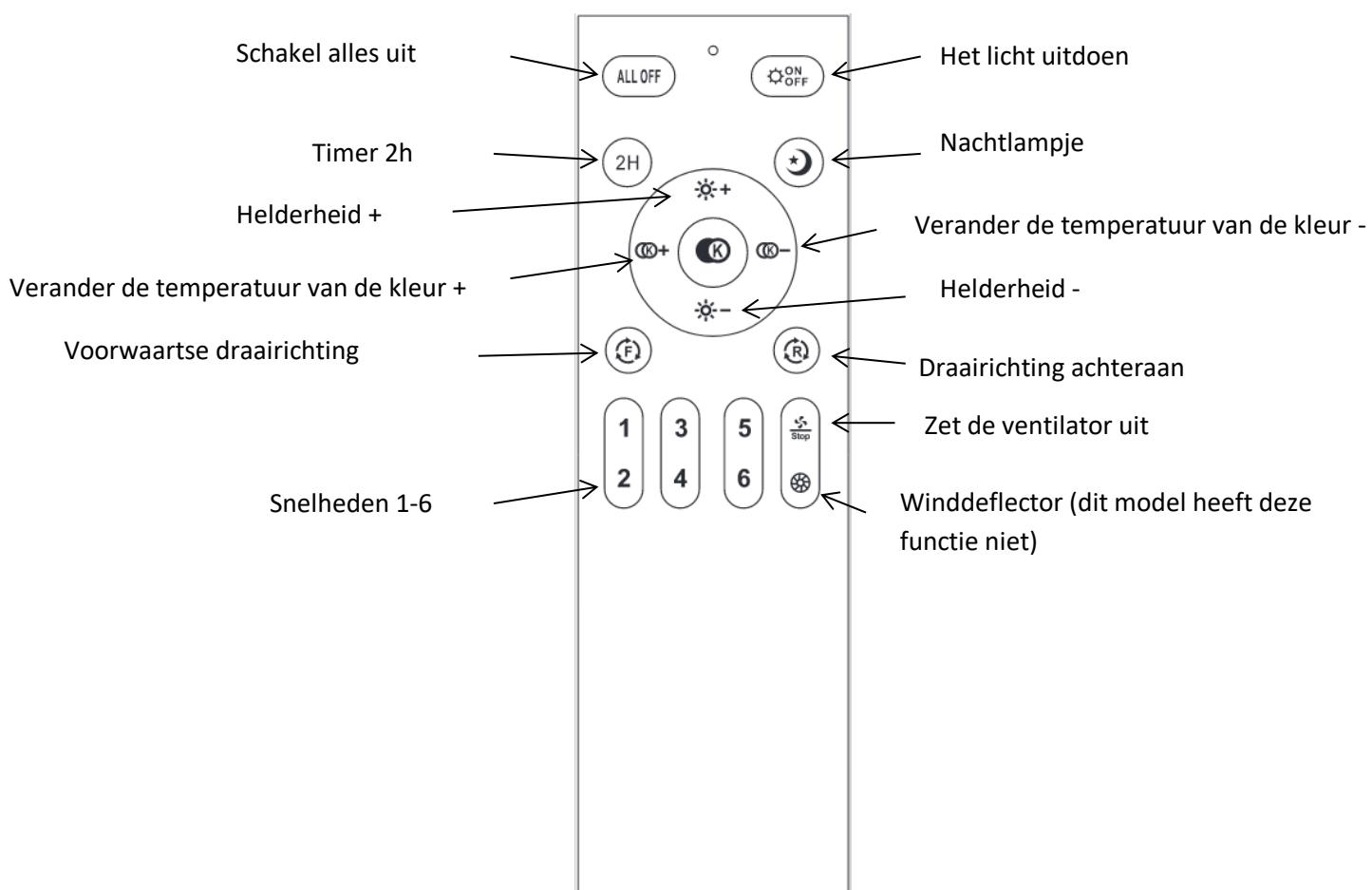
De afstandsbediening vereist geen speciale koppeling en kan worden gebruikt zodra de ventilator is geïnstalleerd.
