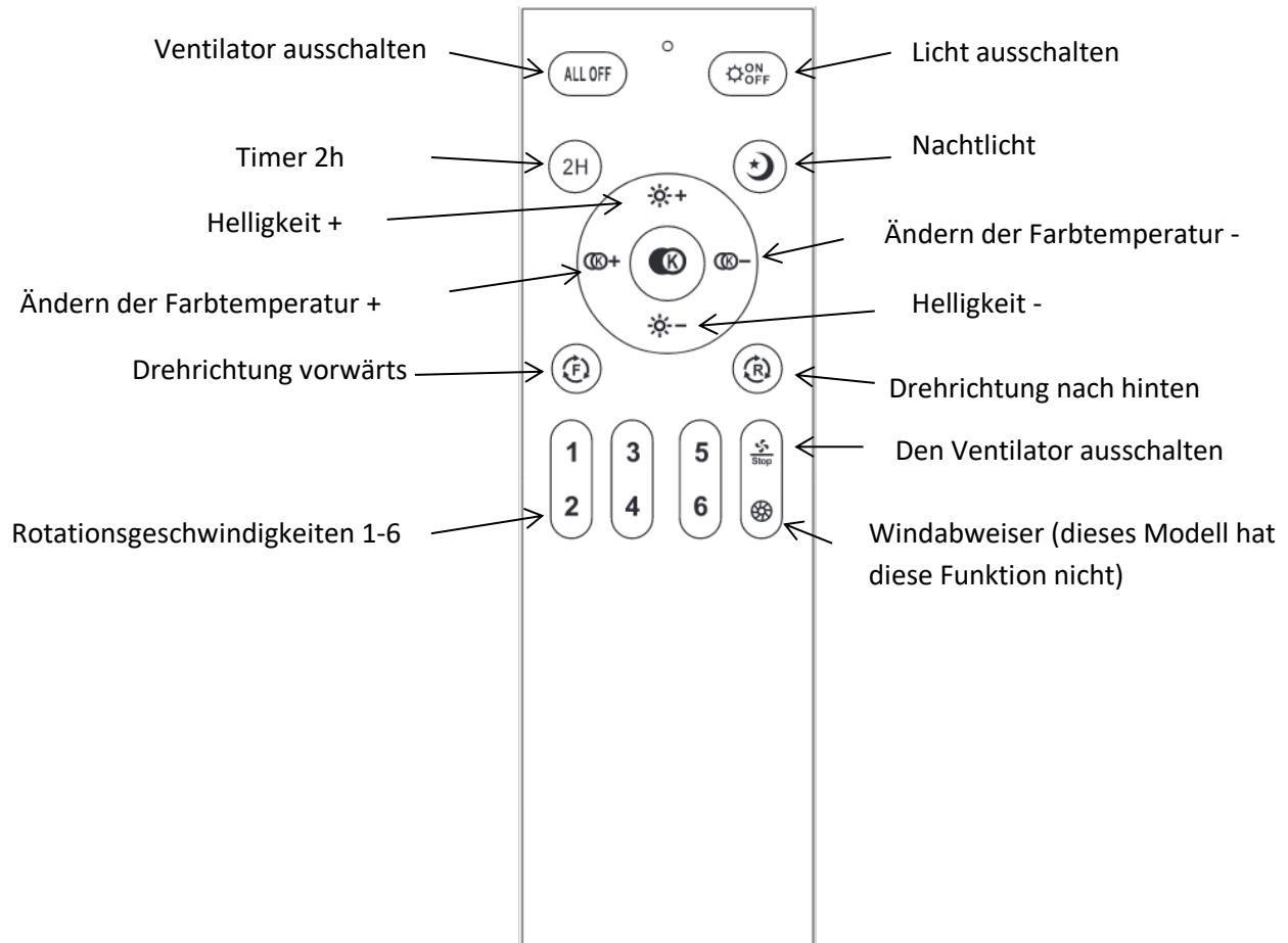
Die Fernbedienung erfordert keine spezielle Kopplung und kann verwendet werden, sobald der Ventilator installiert ist.
